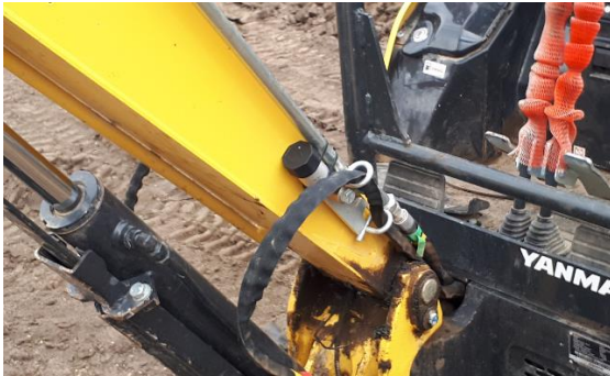
1. ábra: NaBi rögzítése munkagéphez, illetve hűtőgép kompresszorhoz
